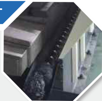
チップ自動排出コンベヤー Automatically remove chips
